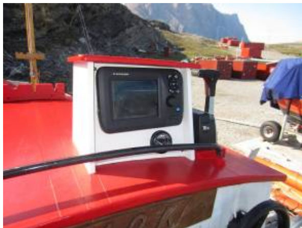
T.v. Udstødningen isoleret med brandhæmmende materiale. Til højre den nye håndlæsepumpe. T.h. Den nye GPS plotter og temperaturføler monteret i en dertil lavet instrumentkasse.
