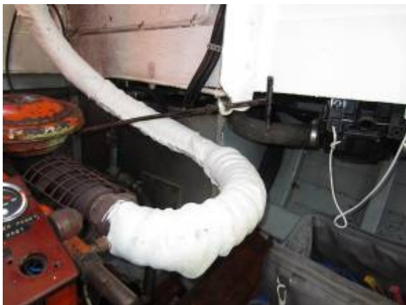
T.v. Udstødningen isoleret med brandhæmmende materiale. Til højre den nye håndlæsepumpe. T.h. Den nye GPS plotter og temperaturføler monteret i en dertil lavet instrumentkasse.
