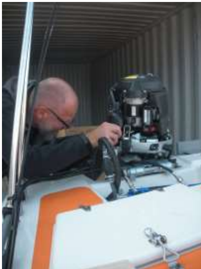
T.v.: Simon monterer motor og hydraulisk styring på Mopa båden. T.h.: Endelig udpakket og klar til det egentlige forskningsarbejde. F.v.: Simon, Toke, Søren og Mopa båden.
