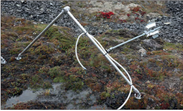
Isbjørneskader på kamerasystemer.
