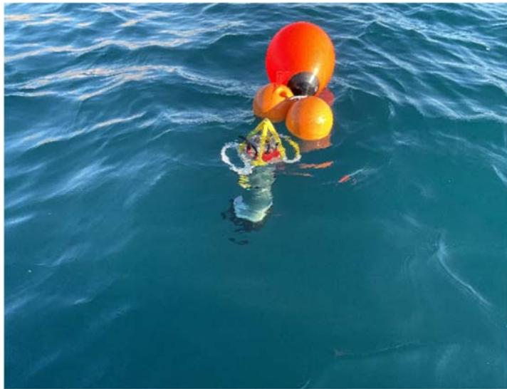
Lucas med ARC-COP målebøjen. Den dykker selv op og ned i vandsøjlen.
