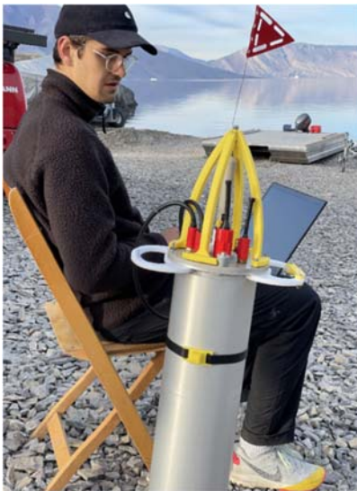
Lucas med ARC-COP målebøjen. Den dykker selv op og ned i vandsøjlen.
