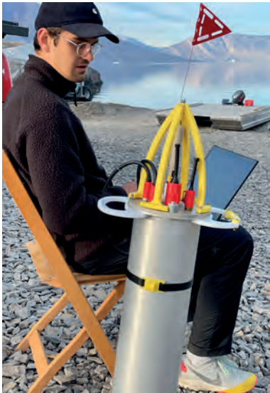
Lucas med ARC-COP målebøjen. Den dykker selv op og ned i vandsøjlen.
