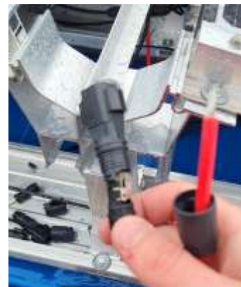
Eksempler på skaderne forårsaget af en piteraqa på GIOS Tasiilaq målestationen.
