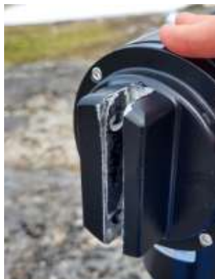
Eksempler på skaderne forårsaget af en piteraqa på GIOS Tasiilaq målestationen.
