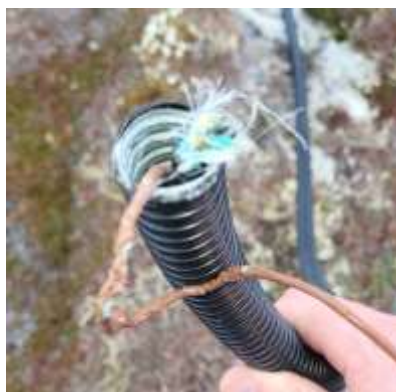
Eksempler på skaderne forårsaget af en piteraqa på GIOS Tasiilaq målestationen.
