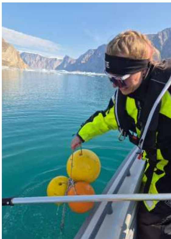
Nanna udsætter inkubationsflasker til måling af primærproduktion i fjorden. Flaskerne fastgøres til en line med flydere, så de kan hænge i vandsøjlen under in situ-forhold og dermed bruges til at bestemme fytoplanktonets primærproduktion.
