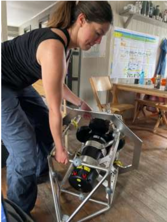
Fleur forbereder en afstrømmålerne (ADCP) til vores 400 m lange undervandsbøje. Tolvmandsbarakken kan bruges til mange gøremål.
