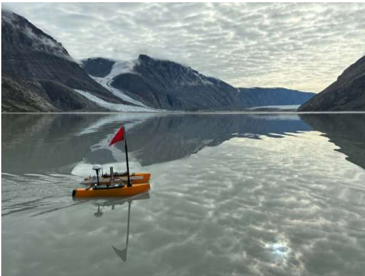
Måling af vandføring fra Rhedin Fjord ved hjælp af dronebåd med ADCP.
